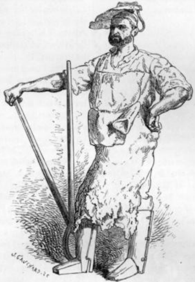
Forgeron au marteau-pilon de la forge à l'anglaise, avec la pince à saisir la loupe. — Dessin de A. de Neuville d'après F. Bonhommé.
